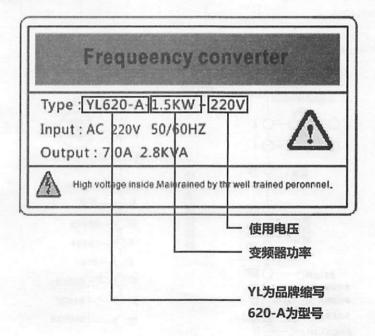
使用电压: Working Voltage 变频器功率: Inverter power YL: Brand abbreviation 型号: model
